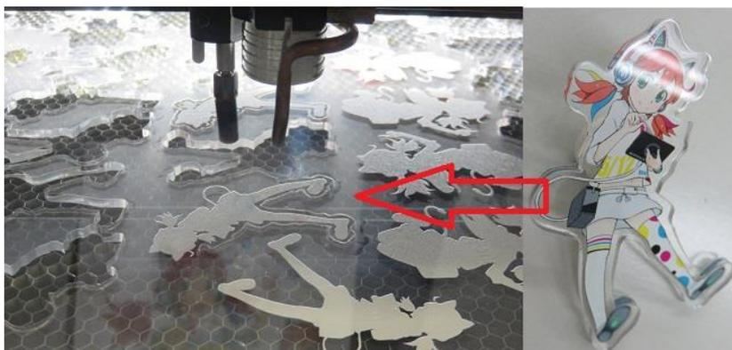
\*グラボテック(株)と共同開発による、自動的にカッティングパスを計算するソリューションを使用し、CO2レーザーLSシリーズにて、印刷データからずれることなくカッティングが可能。
